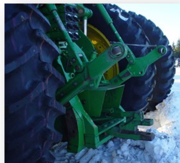
Рисунок 4-3: Полностью поднятый трехо пункта Hitch
