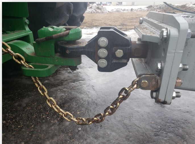
Рисунок 5-2: Прикрепление харвестера к тракторной арматуре
