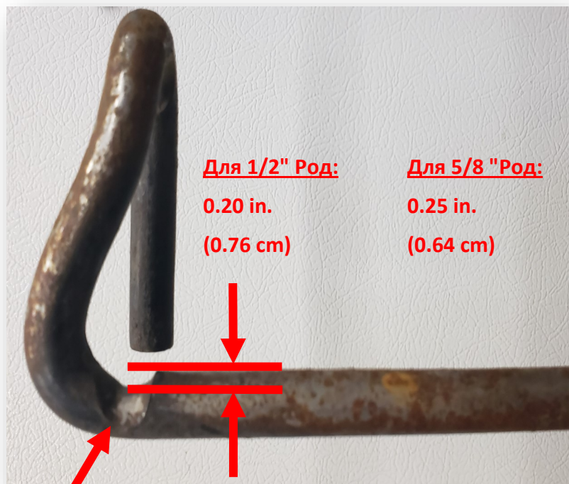
Рисунок 11-8: Крюк Род Цепь износа
